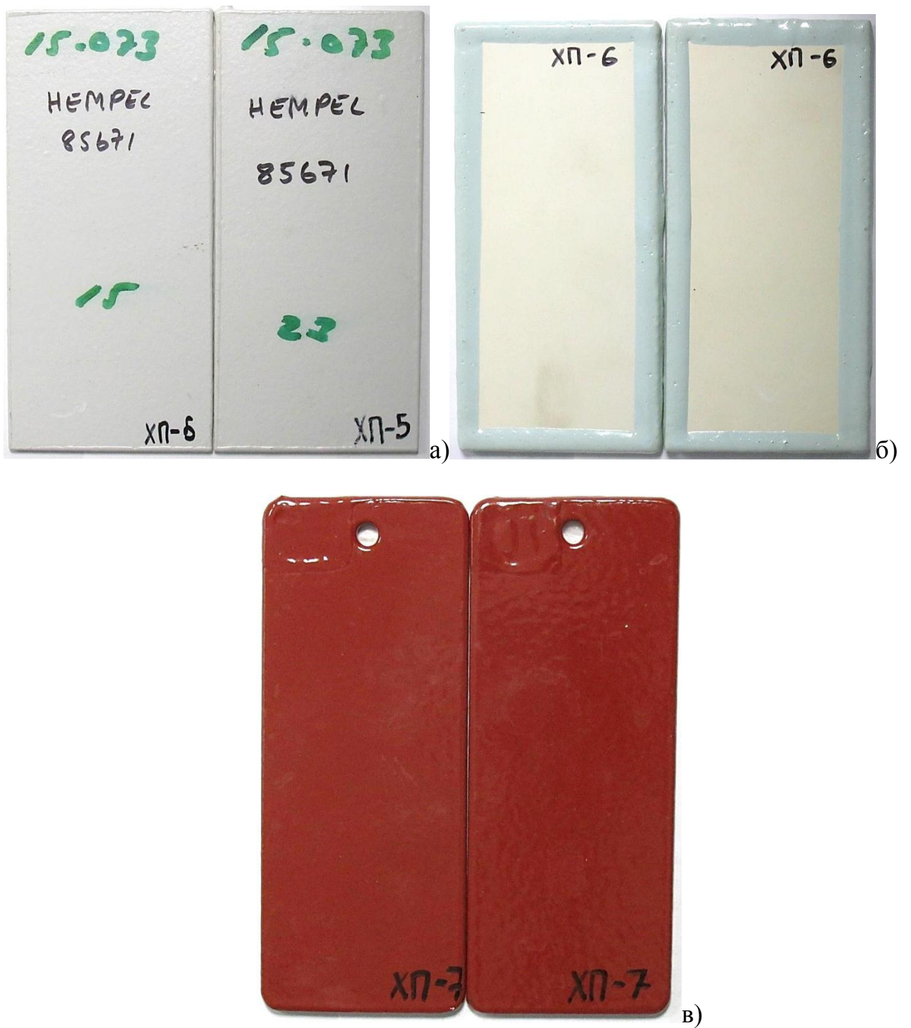
Рис.2 Внешний вид образцов с покрытиями марки HEMPADUR 85671 (а), HEMPALINE DEFEND 630 (б) и VERSILINE TL292-S (в) после испытаний на стойкость к взрывной декомпрессии
