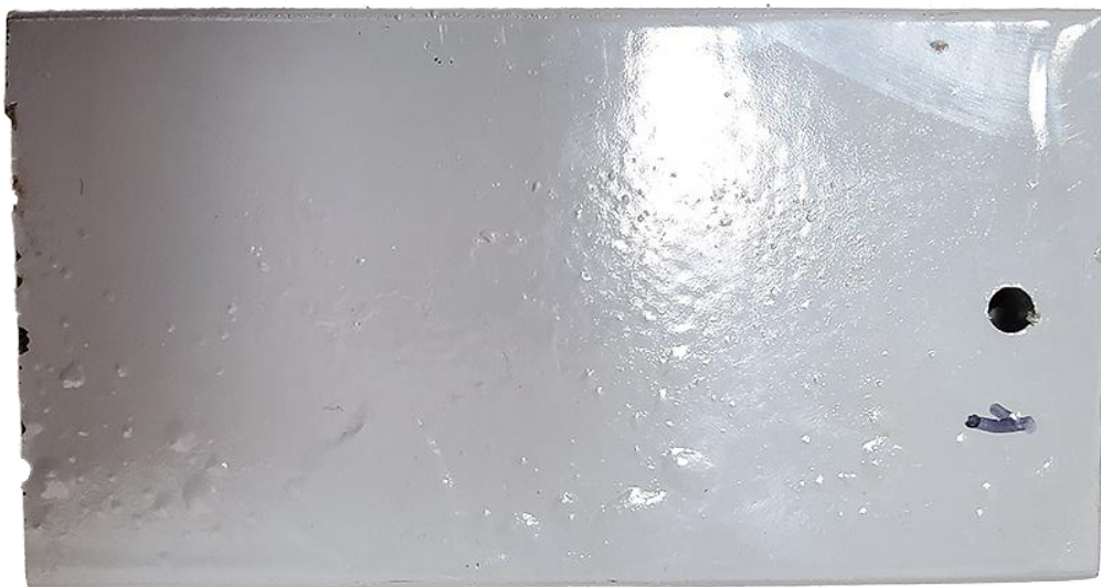
Рисунок 4 – Неподготовленная сторона образца после испытаний
