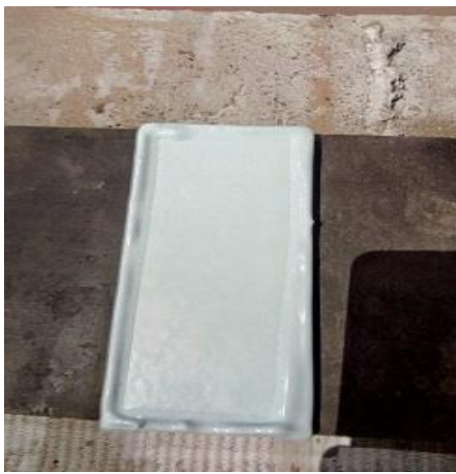
Фото 02. Окрашивание тестовых пластин материалом Hempadur Defend 630
